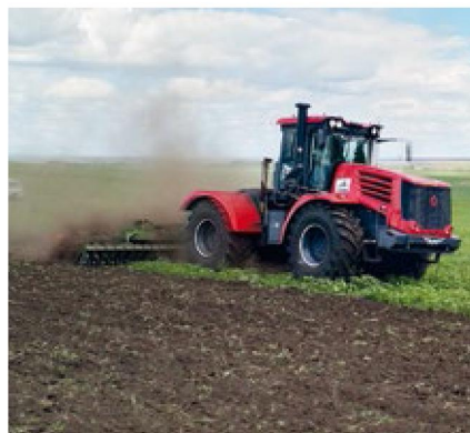
Борона дисковая Catros-6002-2 в агрегате с трактором К-744РЗ
